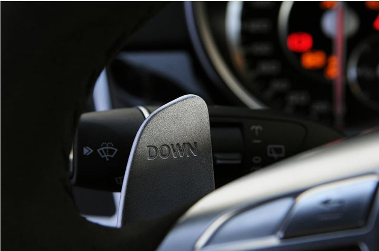
Das Interieur des ML 63 AMG unterscheidet sich unter anderem durch eine spezifische Instrumentierung mit 320-km/h-Tacho, eine mit präzise verarbeitetem Kunstleder bezogene Armaturentafel sowie ein im Stil von Rennwagen unten abgeflachtes Lenkrad mit Alu-Schalt paddeln von den normalen M-Klasse-Typen. Der Lenkstockhebel für die Automatik wurde beibehalten – als überraschend konservatives Element in diesem hochkarätigen AMG-Fahrzeug.
