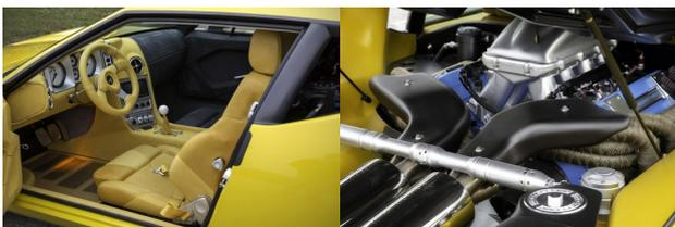
Angetrieben wird der ADRNLN Pantera von einer Wenger-Motorsports-LS3-Einheit, die 600 PS leistet. Ein Fünfgang-Getriebe von ZF überträgt die Kraft auf die Hinterräder. Und, um sicherzustellen, dass das typische Knurren des Pantera erhalten bleibt, wurden zwei Flowmaster-Edelstahl-Schalldämpfer verbaut.
