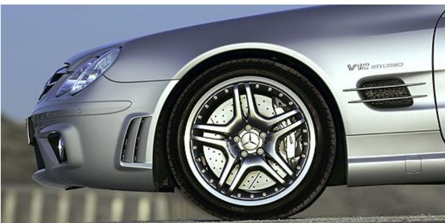
Verzögert werden beide Boliden von neu entwickelten Bremsanlagen: An der Vorderachse kommen groß dimensionierte Bremsscheiben aus Verbundstoff mit Sechskolben-Aluminiumfestsätteln zum Einsatz. Der SL 65 AMG verfügt sogar rundum über 30 Millimeter große Verbundscheibenbremsen.
