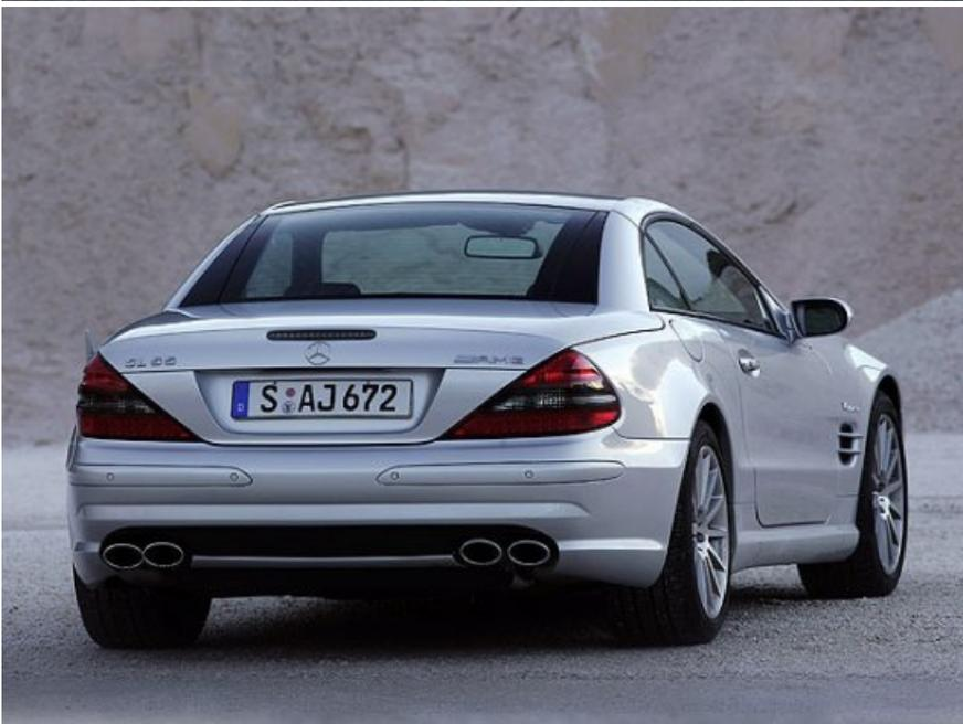
Beim 6,0-Liter-V12-Biturbomotor des SL 65 AMG setzt man dagegen auf bewährte Technik – 612 PS und 1000 Newtonmeter sollen auch für die zweite Generation der Baureihe ausreichen. Laut Mercedes-Benz hält der SL 65 auch jetzt noch den Rekord des stärksten Serien-Roadsters der Welt. Mit dem Sprint von 0 auf 100 km in 4,2 Sekunden bleibt auch der gewollte Abstand zum kleineren Bruder SL 55 gewahrt.
